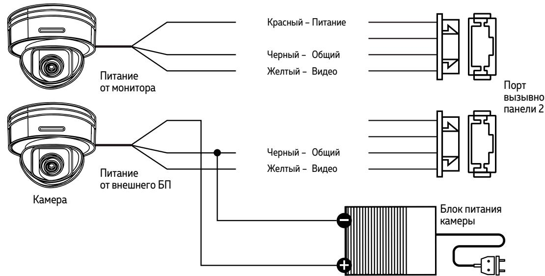
Рис.15 Схема подключения видеокамеры к монитору UNIT FHD
