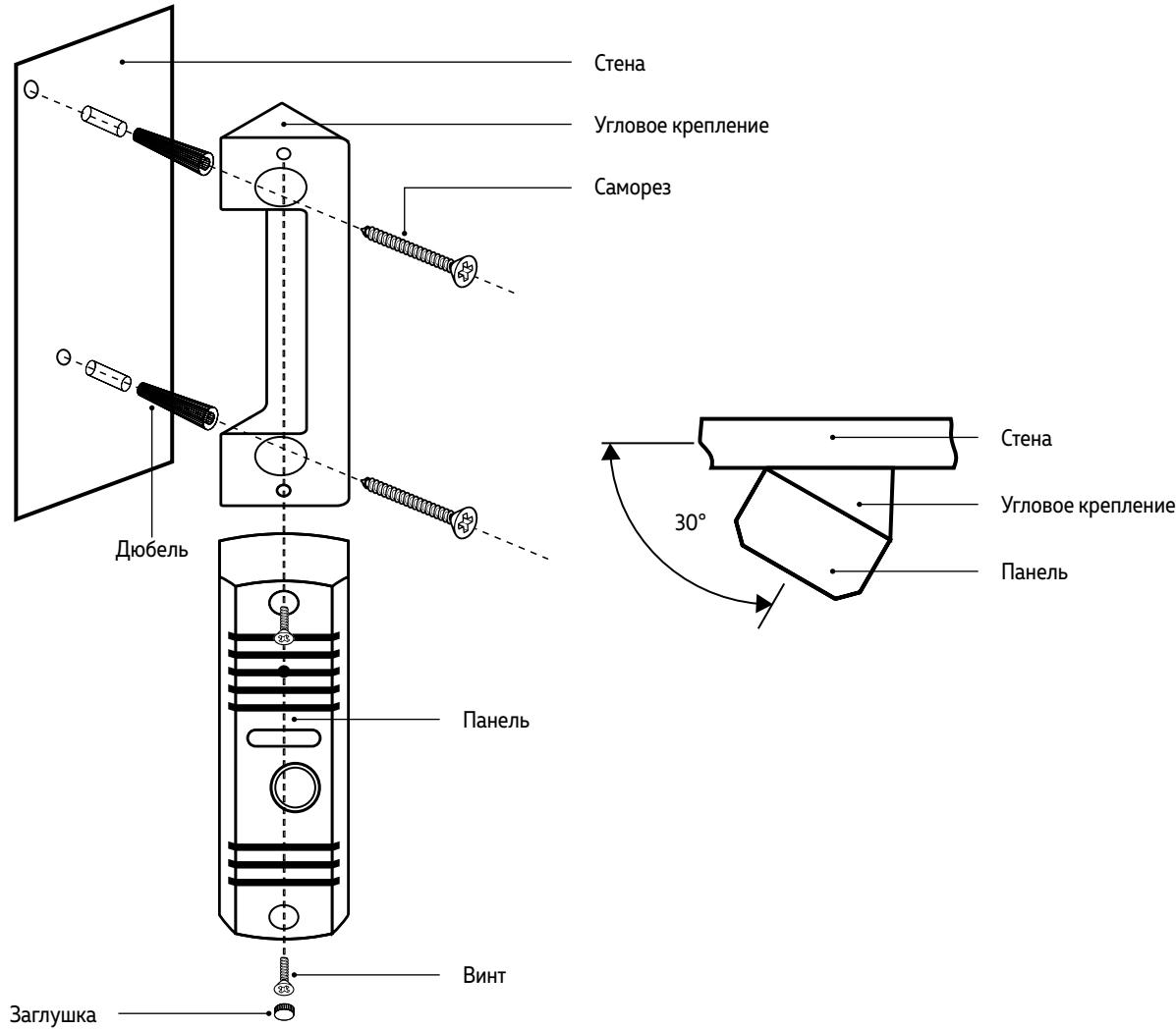
Рис. 7 Установка вызывной панели под углом 30°
