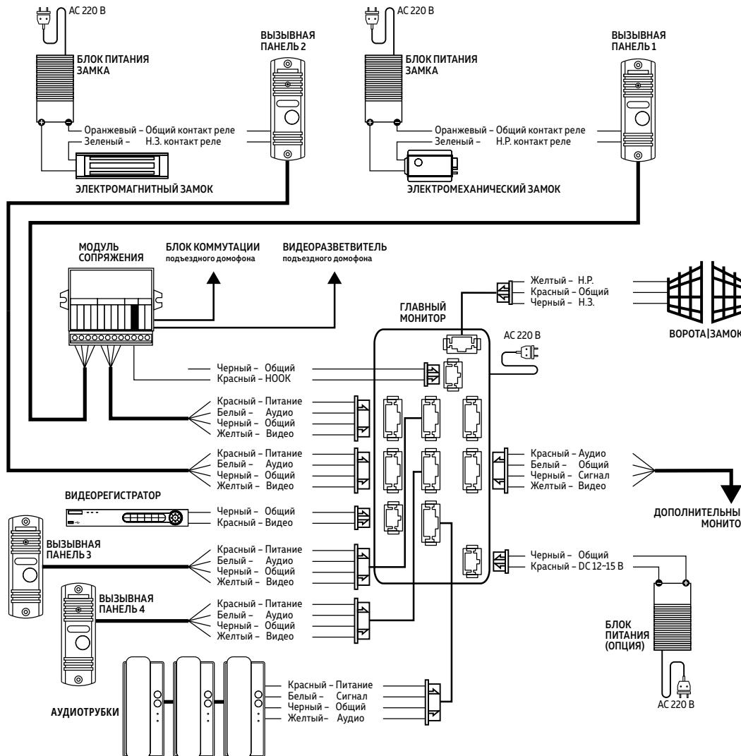
Рис.13 Общая схема подключения видеодомофонов серии UNIT FHD
