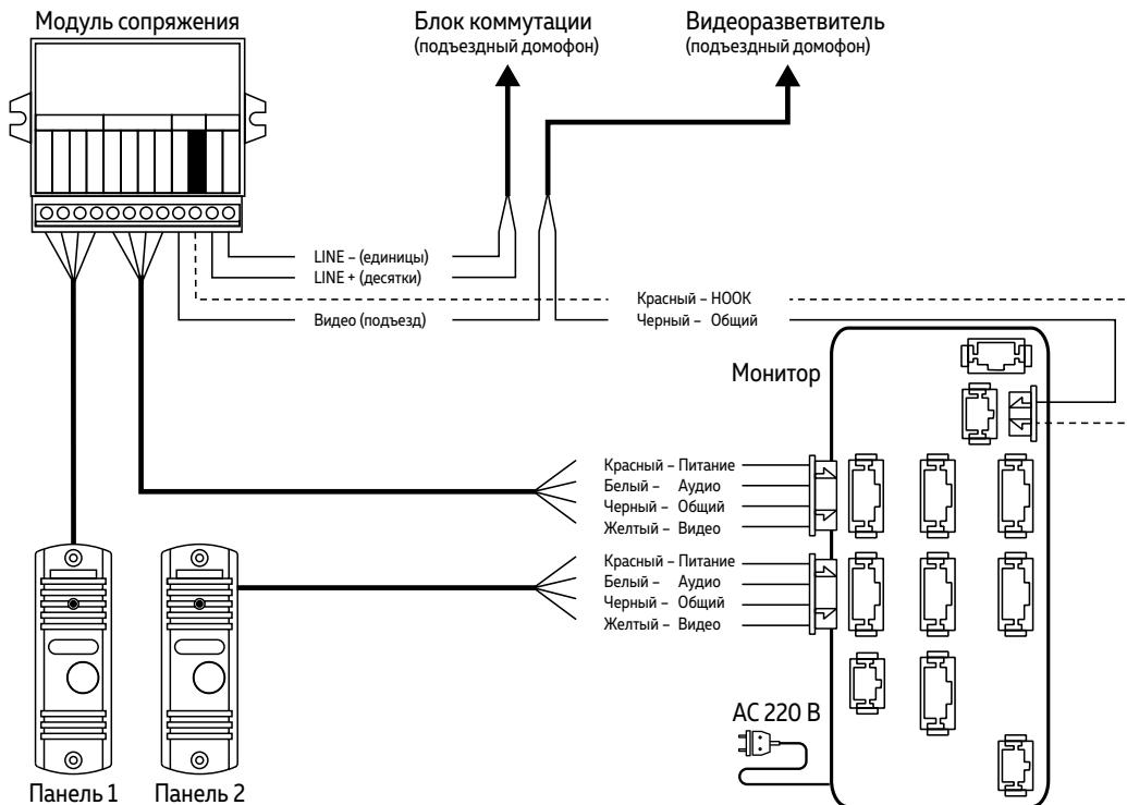
Рис.14 Схема подключения видеодомофонов серии UNIT FHD
