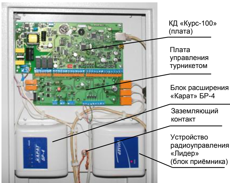
Рис. 2 Внутренняя компоновка турникета SA-303 (открыта передняя дверка)
